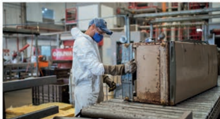
Unidade de manufatura reversa de refrigeradores
